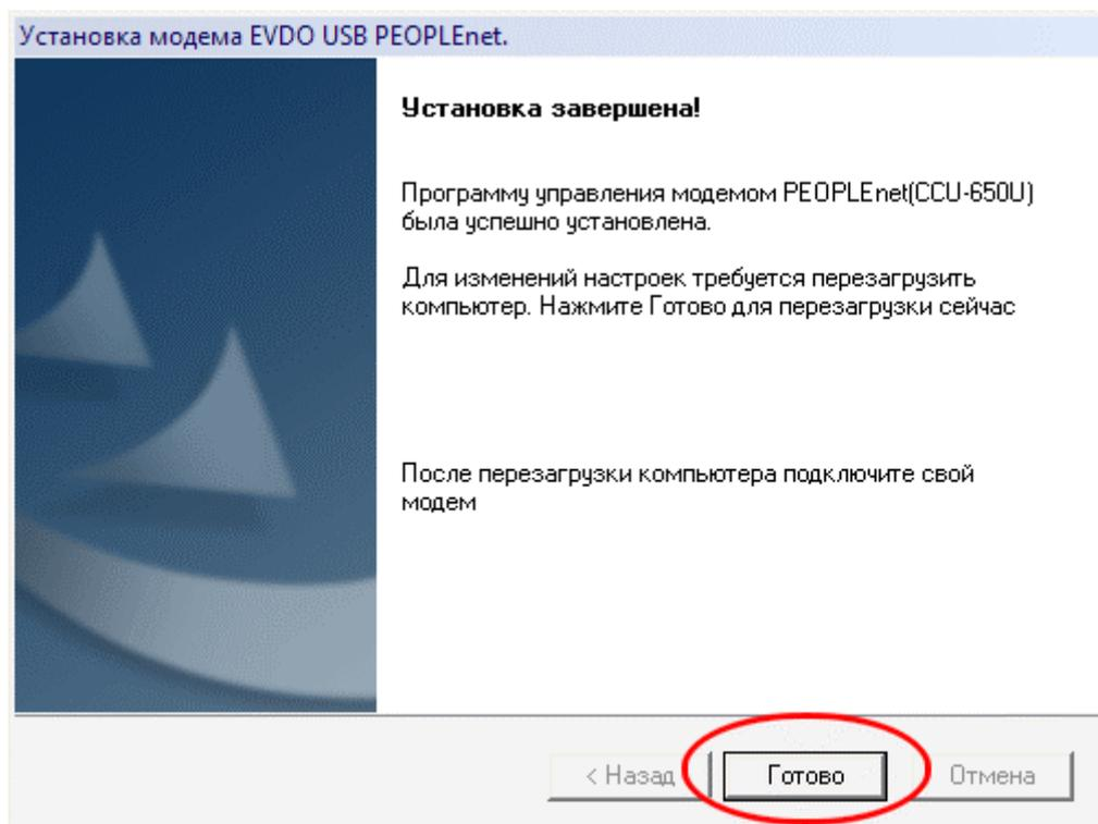
**После перезагрузки компьютера подключите модем Smotech CCU650U к USB порту Вашего компьютера. Система обнаружит новое устройство.**
